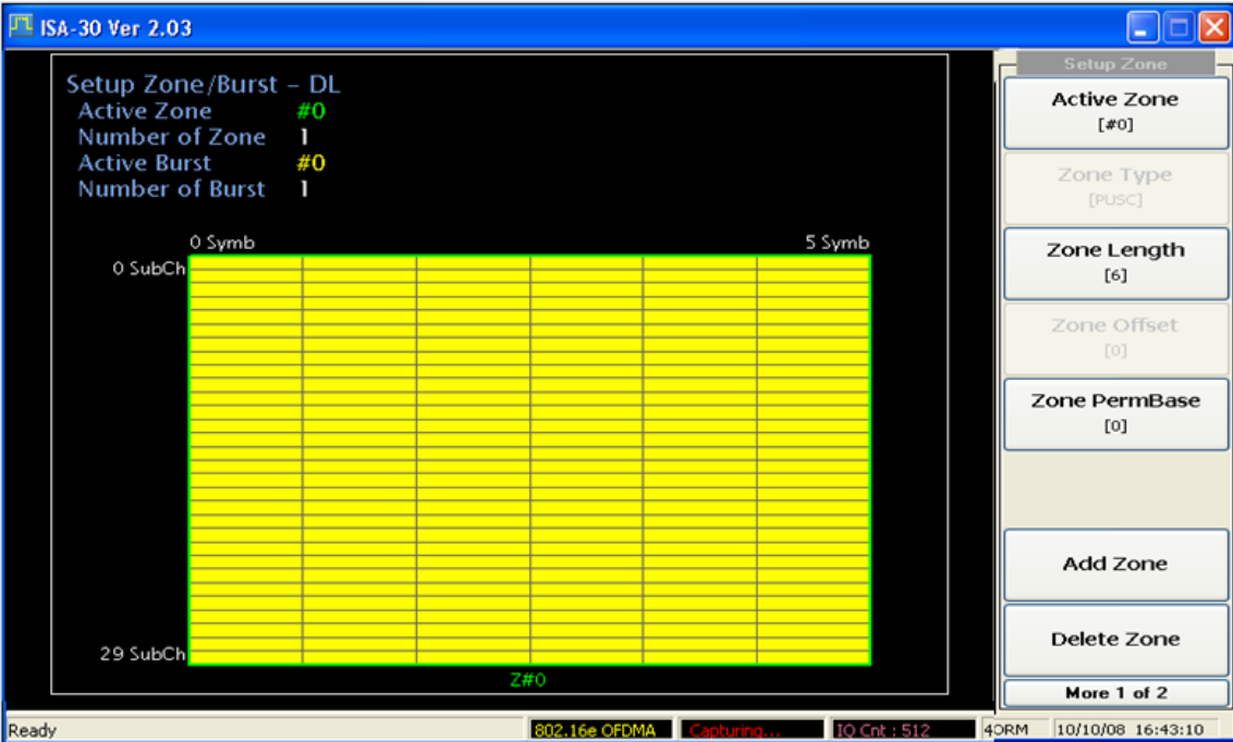
Fig. 2-5 Set up WiMAX Zone, Burst parameters
