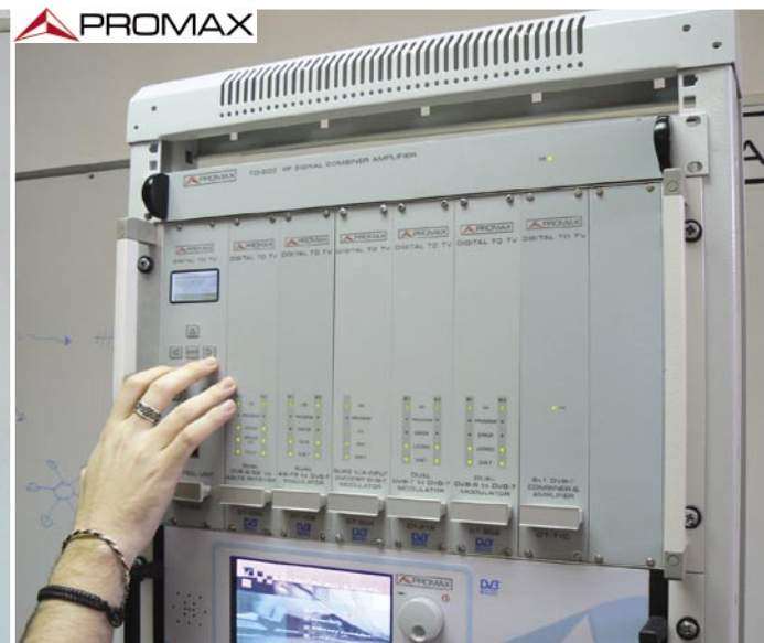
■ Teoriyi bir örnekle gösteriyorlar: her slot muhtemel bir sinyal kaynağını gösteriyor. Diğer uçtan kombine bir DVB-T sinyali olarak çıkıyor.
